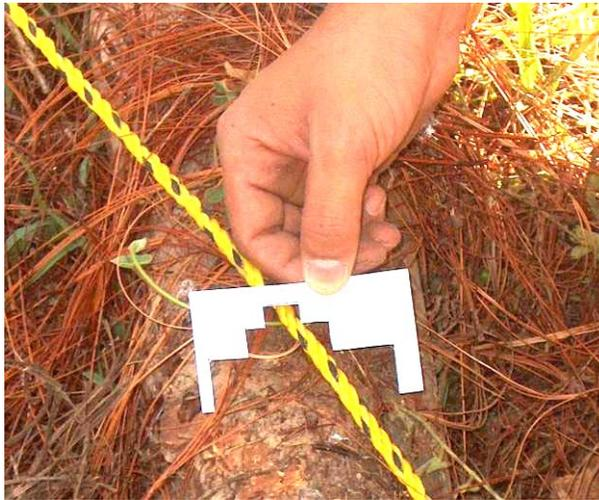
**Figura 21. Medición de combustibles de 1000 horas con calibrador.**
