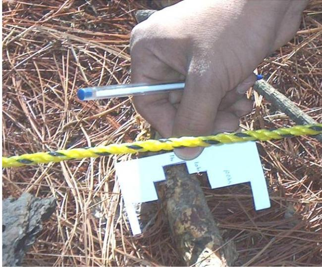
**Figura 19. Medición de combustibles de 10 horas con calibrador.**
