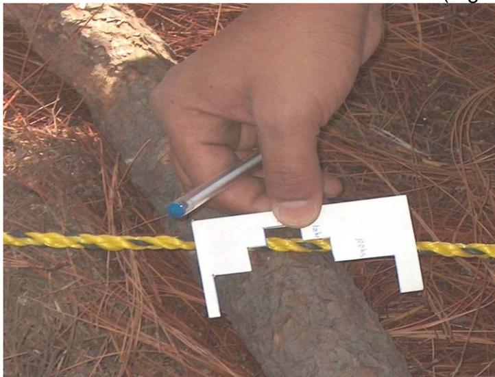
**Figura 20. Medición de combustibles de 100 horas con calibrador.**
