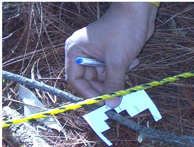
**Figura 18. Medición de combustibles de 1 hora con calibrador.**
