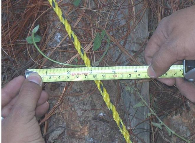
**Figura 22. Medición de combustibles de 1000 horas utilizando flexometro.**
