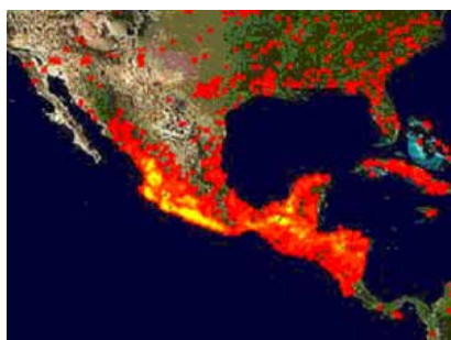
FIGURA 1. Los incendios forestales afectan anualmente áreas extensas de México. El compuesto en falso color de imágenes de satélite y puntos de calor detectados sobre el territorio mexicano (celdas rojas indican un incendio y amarillas dos o más incendios) en los primeros 10 días de mayo de 2005 muestra la incidencia de incendios sobre el territorio mexicano esos primeros días. (Fuente: http://rapidfire.sci.gsfc.nasa.gov/firemaps/firemap.2005121-005130 ).
